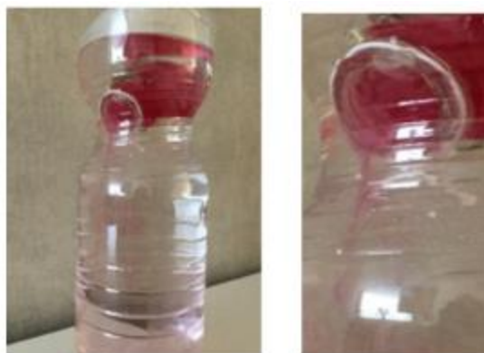
Figure n° 7 : Introduction d'eau froide au sommet d'un grand récipient d'eau chaude (Source : ESA CCI)
