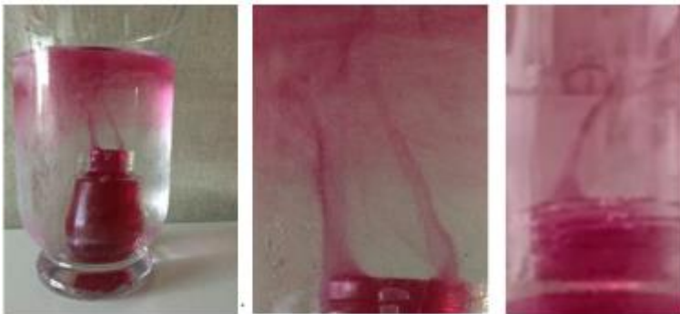
Figure n° 4 : Résultats pour un grand récipient d'eau froide, un petit récipient d'eau chaude (Source : ESA CCI)
