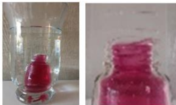
Figure n° 5 : Résultats pour un grand récipient d'eau chaude, un petit récipient d'eau froide (Source : ESA CCI)
