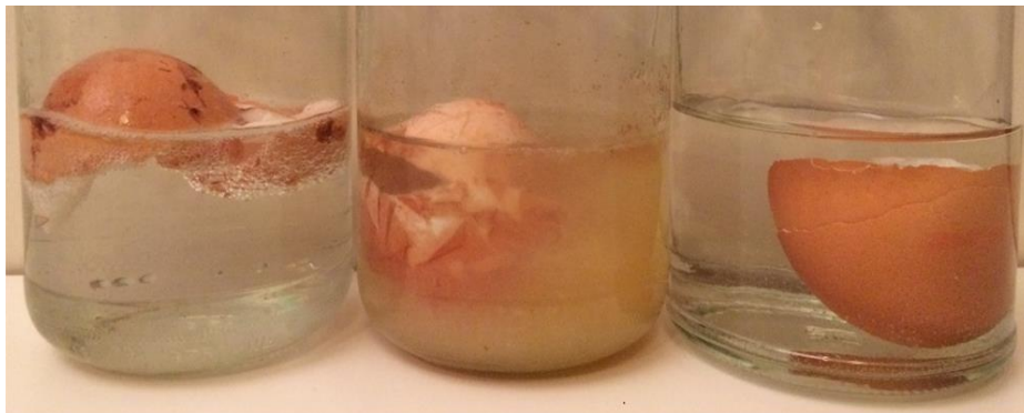
Figuur 5: Eierschalen in azijn, citroensap en water na ongeveer een uur (Bron: ESA CCI)
