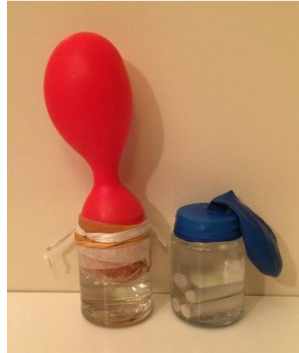
Figuur 8: Ballonnen voor deel 2 van de activiteit na enkele uren: eierschaal en azijn (links), krijt en azijn (rechts) (Bron: ESA CCI)
